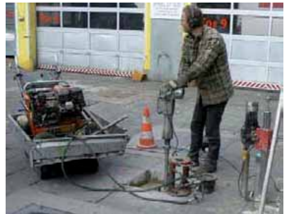
Abb. 1: Rammsondierung (Quelle: Präsentation von C. Köstler)
