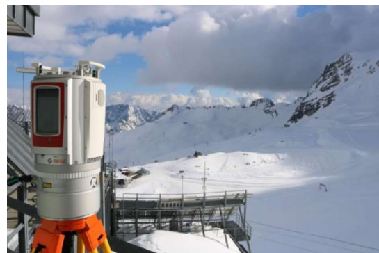
Abb.1: Terrestrischer Laserscanner im Außenbereich der UFS
