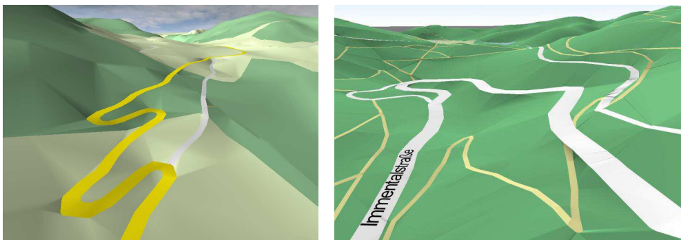
Abb. 4: Durch die Einebnung von Straßen wird die Qualität des Geländemodells verbessert.
