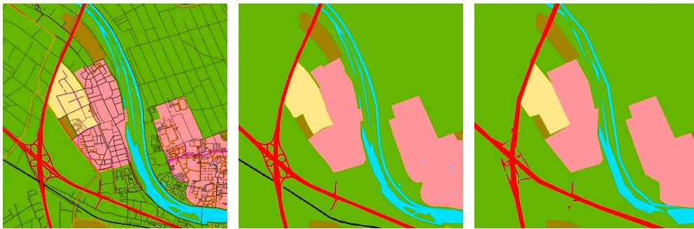
Abb. 3: Generalisierungsstufen des Geländes (Aufsicht). Links: 500 m, Mitte: 8 km, Rechts: 16 km Kacheln.
