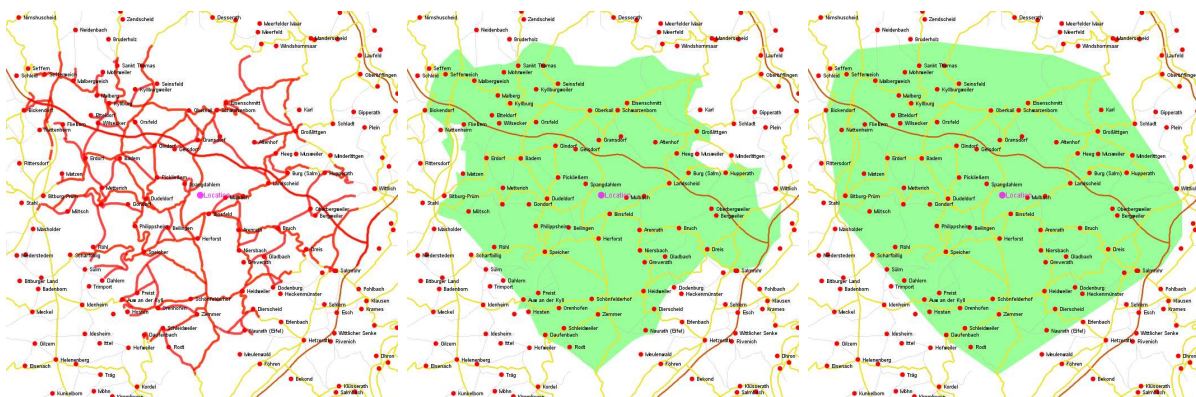
Abbildung 13: Beispiele für 3 Ergebniskarten mit unterschiedlichen Verfahren zur Darstellung des Erreichbarkeitspolygons a.) gepufferte Strassengeometrie, b.) Isolinienberechnung c.) konvexe Hülle
